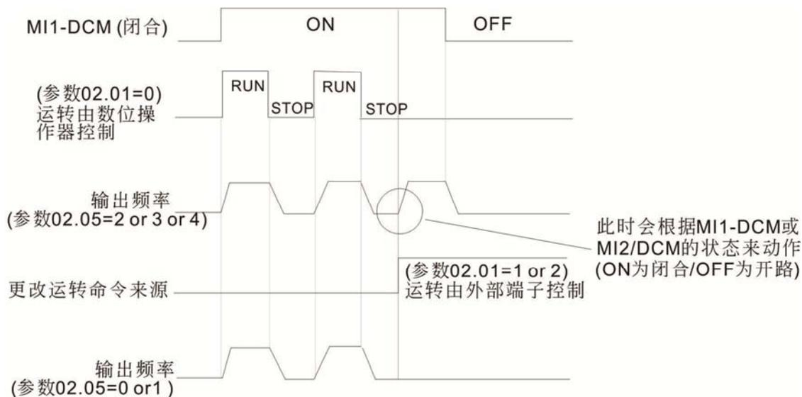
☞ 当此参数的功能设定 1, 3 时, 驱动器不能保证绝对不会运转。因可能受到机械的震动或开关零件的不良导致产生开关的弹跳现象而造成运转, 使用此功能时务必小心。
