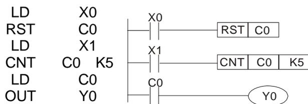
1. 当 X0=On 时 RST 指令被执行, C0 的现在值归零, 输出接点被复归为 Off。
