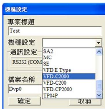
通信設置：依所需的通訊方式進行設定
