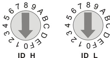
例如：用户需要将 CME-COP01 的通讯地址设置为 26 (1AH)，只需要将旋钮开关 ID\_H 旋转到“1”位置，将旋转开关 ID\_L 旋转到“A”位置即可。
