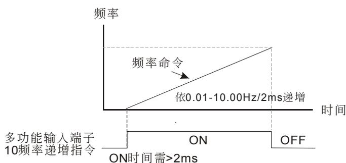
☞ 设定值为 3 时，以多功能输入端子 ON/OFF 一次算一个脉波输入，依据参数 02.08 之设定值来递增/递减频率命令(F)。
