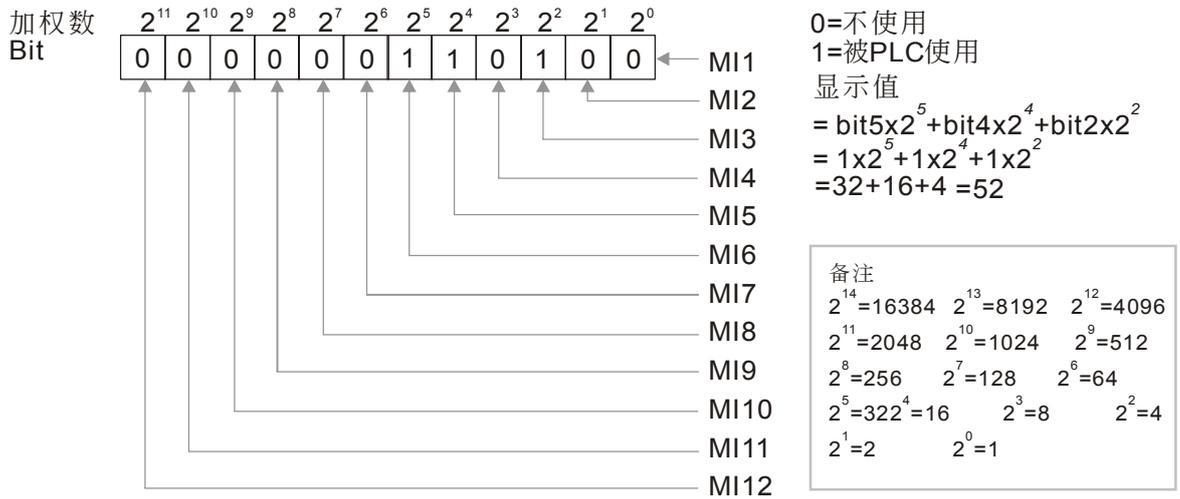
**04.25** 显示被 PLC 所使用的模拟输入端子状态 『CANopen 机种无此功能』
