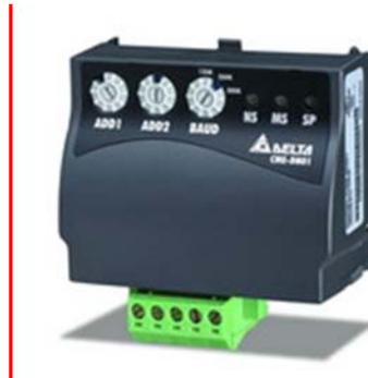
面板尺寸外观：里头包含一个与 VFD-E 系列连接的 RS-485 通讯接口，连接 DeviceNet 通讯网络接口，以及地址和鲍率的选择开关，还有三个状态显示灯以显示目前此通讯模块运行状态。请见下图。
