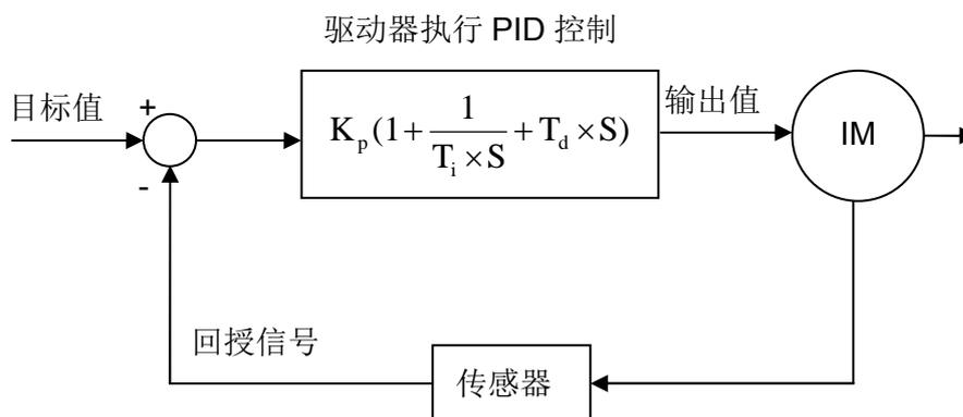
$K_p$  比例值增益(P 控制),  $T_i$  积分时间(I 控制),  $T_d$  微分时间(D 控制),  $S$  演算子
