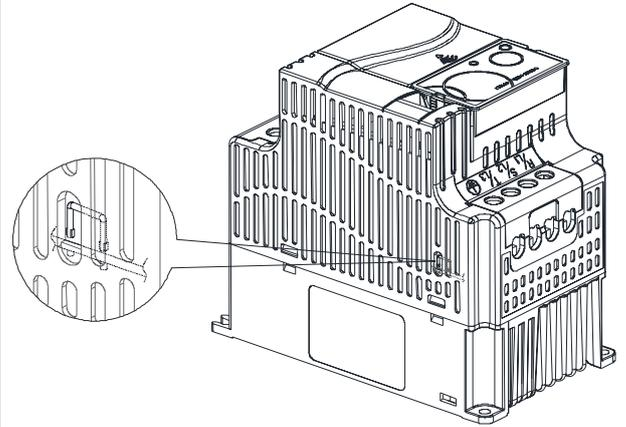
框号 C (230V), 靠近输入侧(R/L1, S/L2, T/L3)处。框号 C (460V), 靠近输入侧(R/L1, S/L2, T/L3)处。
