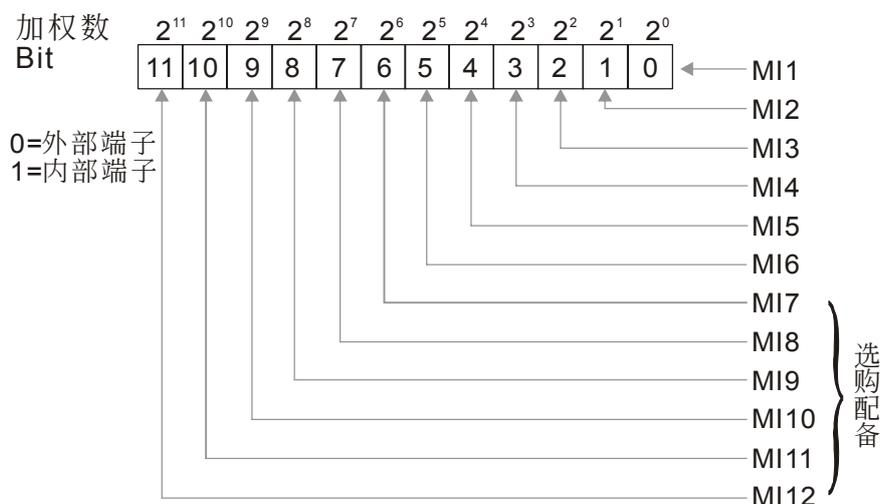
设定方法：内部端子的设定是以二进制 12bit 的方式设定再转成 10 进位的值，才可输入本参数。
