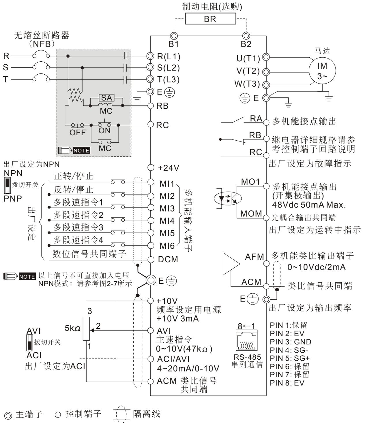
**NOTE** 建议客户在控制端子RB-RC加装异常或电源瞬间断路保护线路
