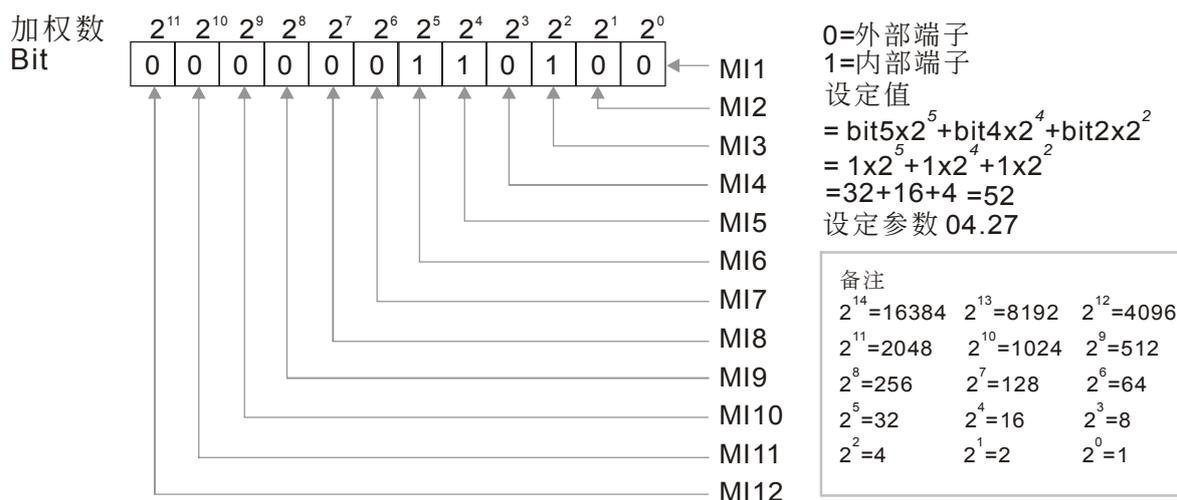
**04.28** 内部多功能输入端子接点状态设定
