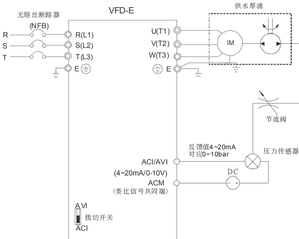
1. 参数 00.04 设定为 5 显示 PID 模拟回授信号值。
