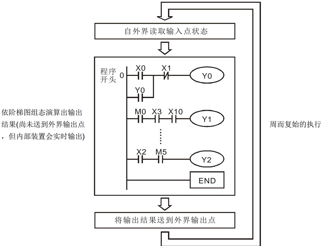
依阶梯图组态演算出输出结果(尚未送到外界输出点, 但内部装置会实时输出)
