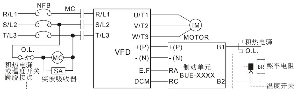
■ 当交流马达驱动器有加装直流电抗器 (DC Reactor)时, 其煞车模组之电源输入回路
