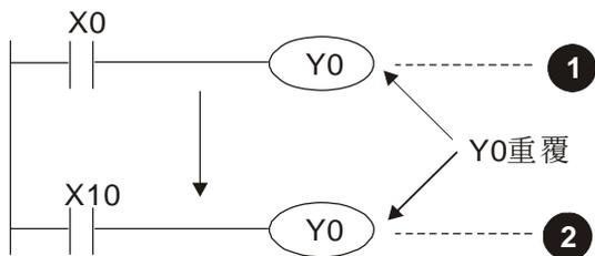
Y0的输出最後会由电路 ② 決定，亦即由X10的ON/OFF決定Y0的输出。
