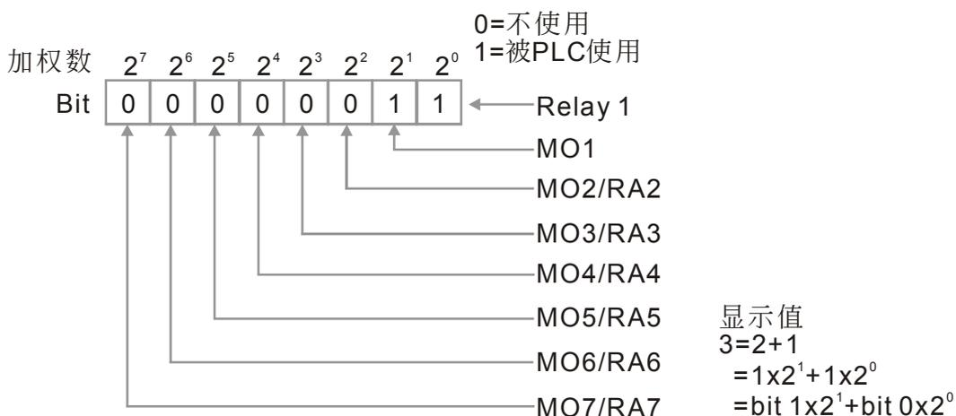
**03.10** 显示被 PLC 所使用的模拟输出端子 『CANopen 机种无此功能』
