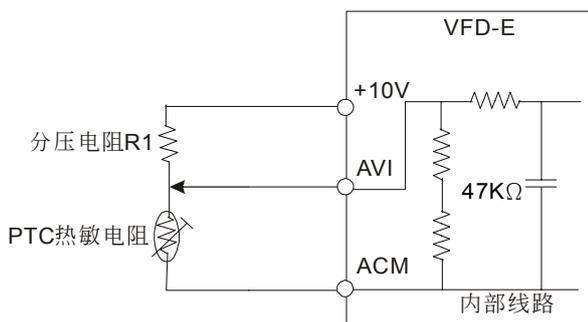
范例：以标准 PTC 电阻为例保护准位为 1330Ω，+10V-ACM 实际量测值=10.5V，分压电阻 R1=4.4KΩ。
