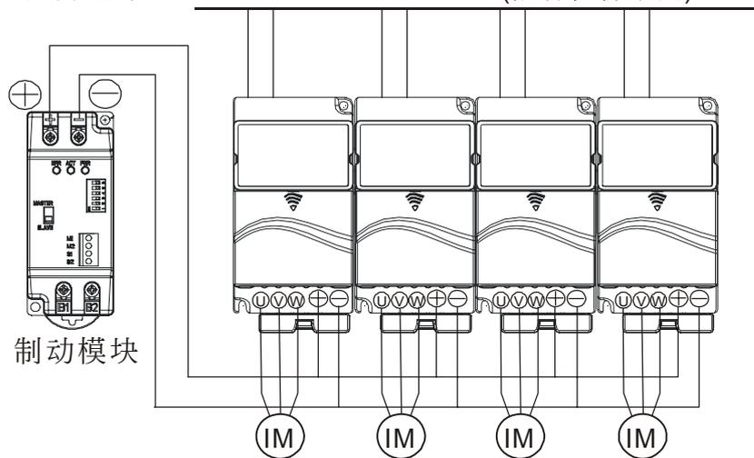
框号 A 端子+, - 接到制动模块的+, -
