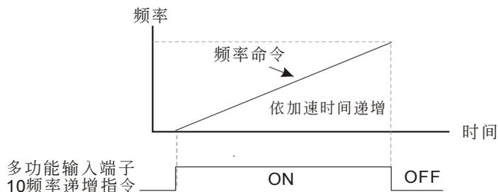
☞ 设定值为 2 时，以多功能输入端子 ON/OFF，依据参数 02.08 之设定值 0.01~10.00Hz/2ms 来递增/递减频率命令(F)。
