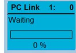
2. 开启 VFDSOft 软件 =>点选“参数总管”=>点选右上功能选项“表格”=>选择“从 KPC-CC01 加载参数表”=>此时会出现“通信设置”窗口=>请选择 PC 与 KPC-CC01 连接对应之通讯端口后按下 OK。
