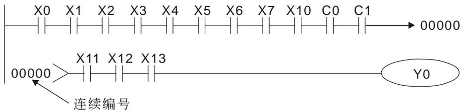
阶梯图程序的运作方式是由左上到右下的扫描。线圈及应用命令运算框等属于输出处理, 在阶梯图形中置于最右边。以下图为例, 我们来逐步分析阶梯图的流程顺序, 右上角的编号为其顺序。
