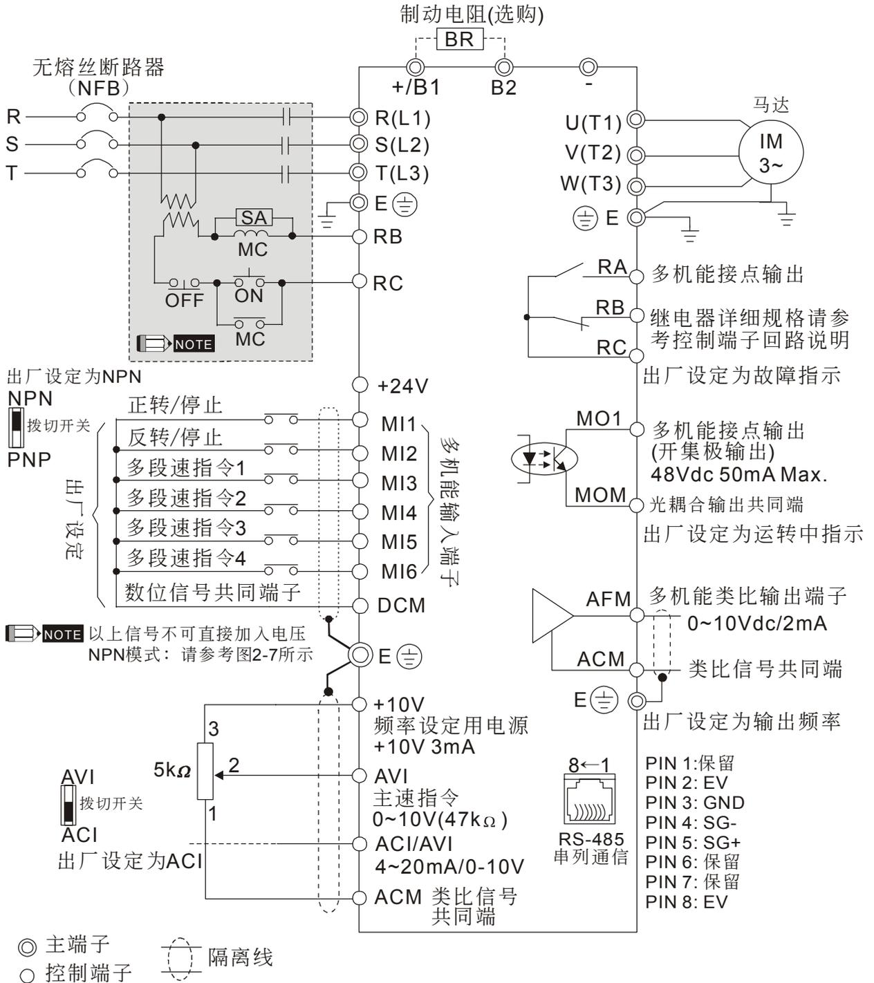
**NOTE** 建议客户在控制端子RB-RC加装异常或电源瞬间断路保护线路
