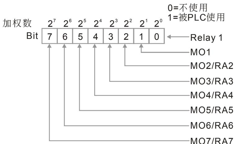
范例：参数 03.09 显示值为 3，表示 Relay1 和 MO1 是被 PLC 程序所使用到的。
