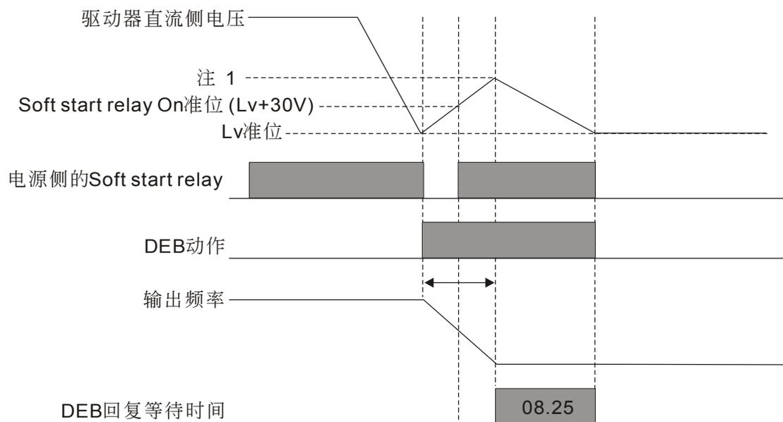
注 1 230Vac 机种 LV+30V => Soft Start relay on 准位
