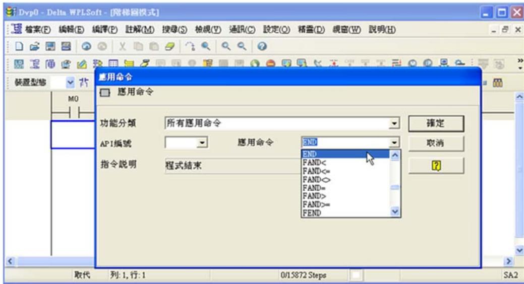
6. 點選
